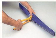
κοπή οπής κατά πλάτος για αμφίπλευρο σύστημα άρδευσης
